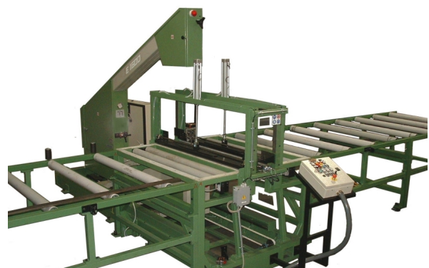
↑ Rouleaux de guidage de lames de scies - Application de Scies à Ruban
