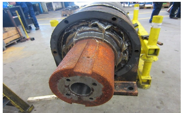
↑ Assemblage roulement à rouleaux et logement SWR
